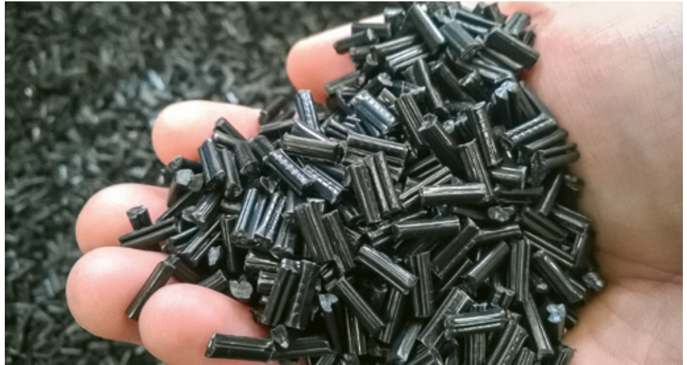
Recyclinggranulat aus Rahmen der DUO Universalschalung
