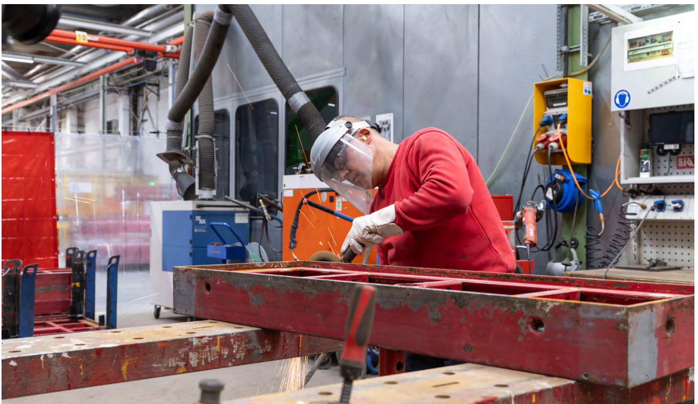
Wiederaufbereitung eines PERI-Verschalungselements.
