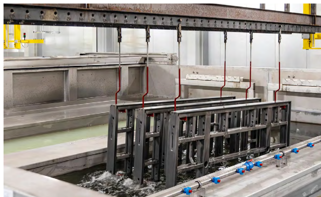
Die Tauchbeschichtung findet bei nur 20 Grad Celsius statt.
